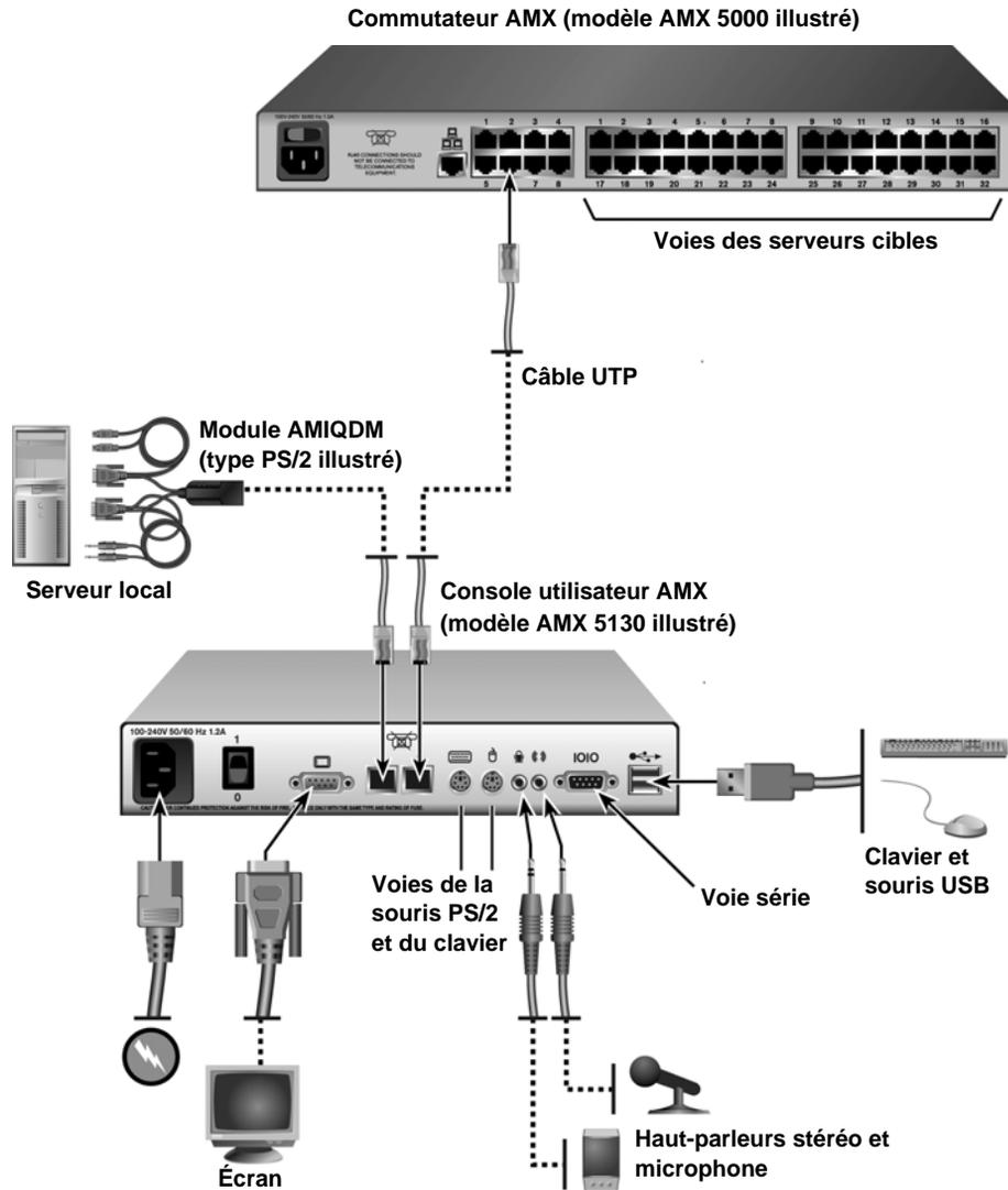
Figure 2.8 : Connexion d'utilisateurs à un commutateur AMX
