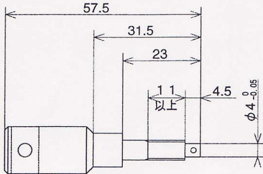
[抜け止めの構造]
