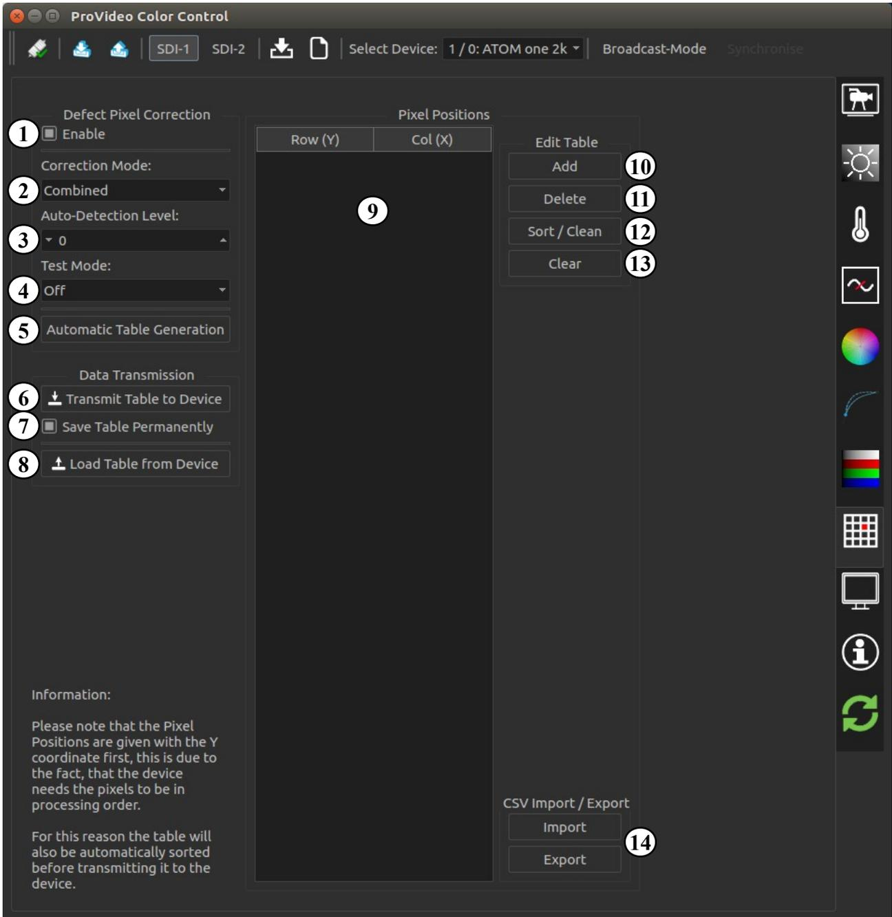
**Defect Pixel Correction**
