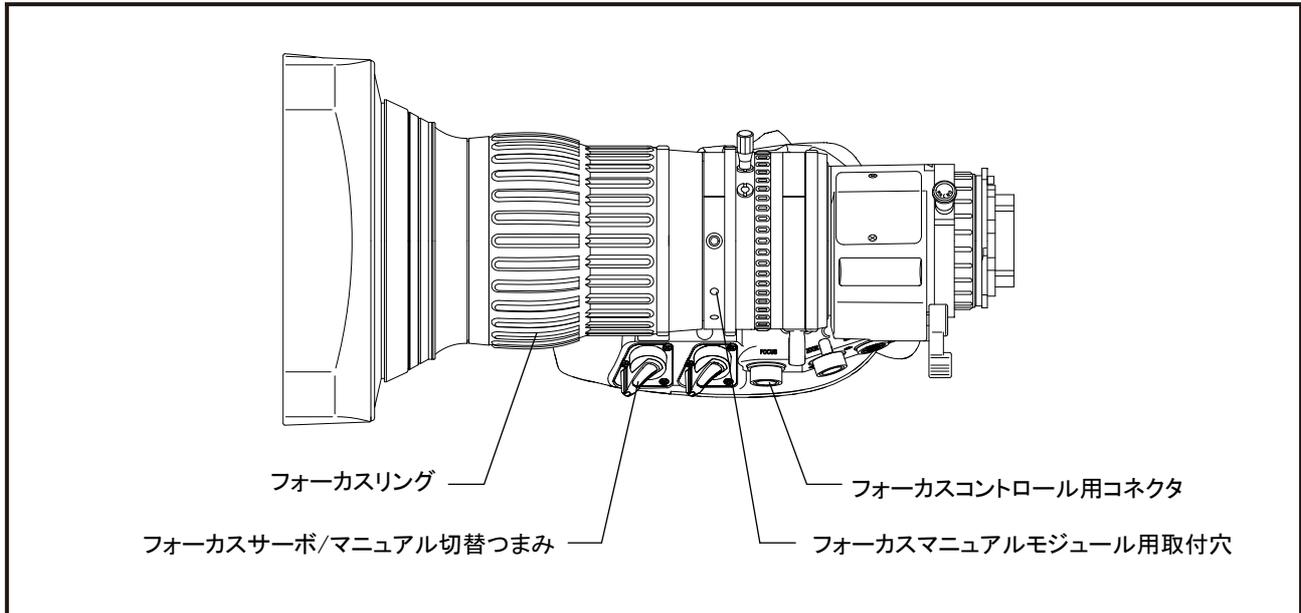
フォーカスリングを直接手で回して、焦点を合わせます。
