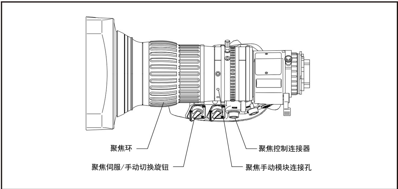
直接手动旋转聚焦环便可聚焦。从摄像机一端顺时针转动聚焦环，可聚焦近处的对象；逆时针旋转聚焦环可聚焦远处的对象。
