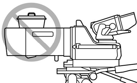
于拍摄角度大于或小于俯仰/下垂角度 $45^{\circ}$ 时，镜头有可能从摄像上脱落。在这个前提下，请考虑使用的安全措施。需要按上述姿势进行拍摄时，请注意采取措施防止镜头脱落。
