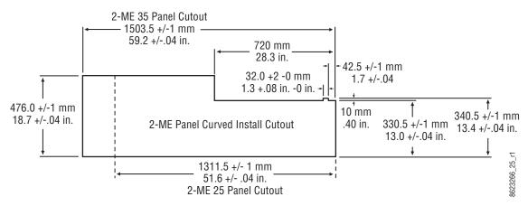
2-M /E ControlPanelCutoutD im ensions, Curved Installation
