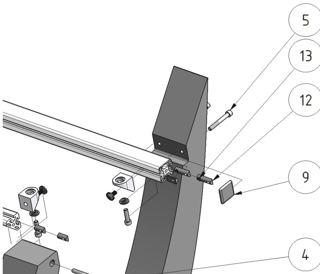
6. Die vier Gewindestifte M8x10 (Pos.13) in die 4 Nutensteine (Pos.12) drehen und in das Rechteckprofil (Pos.8) schieben, ausrichten und mit Gewindestift an definierter Stelle fixieren.
