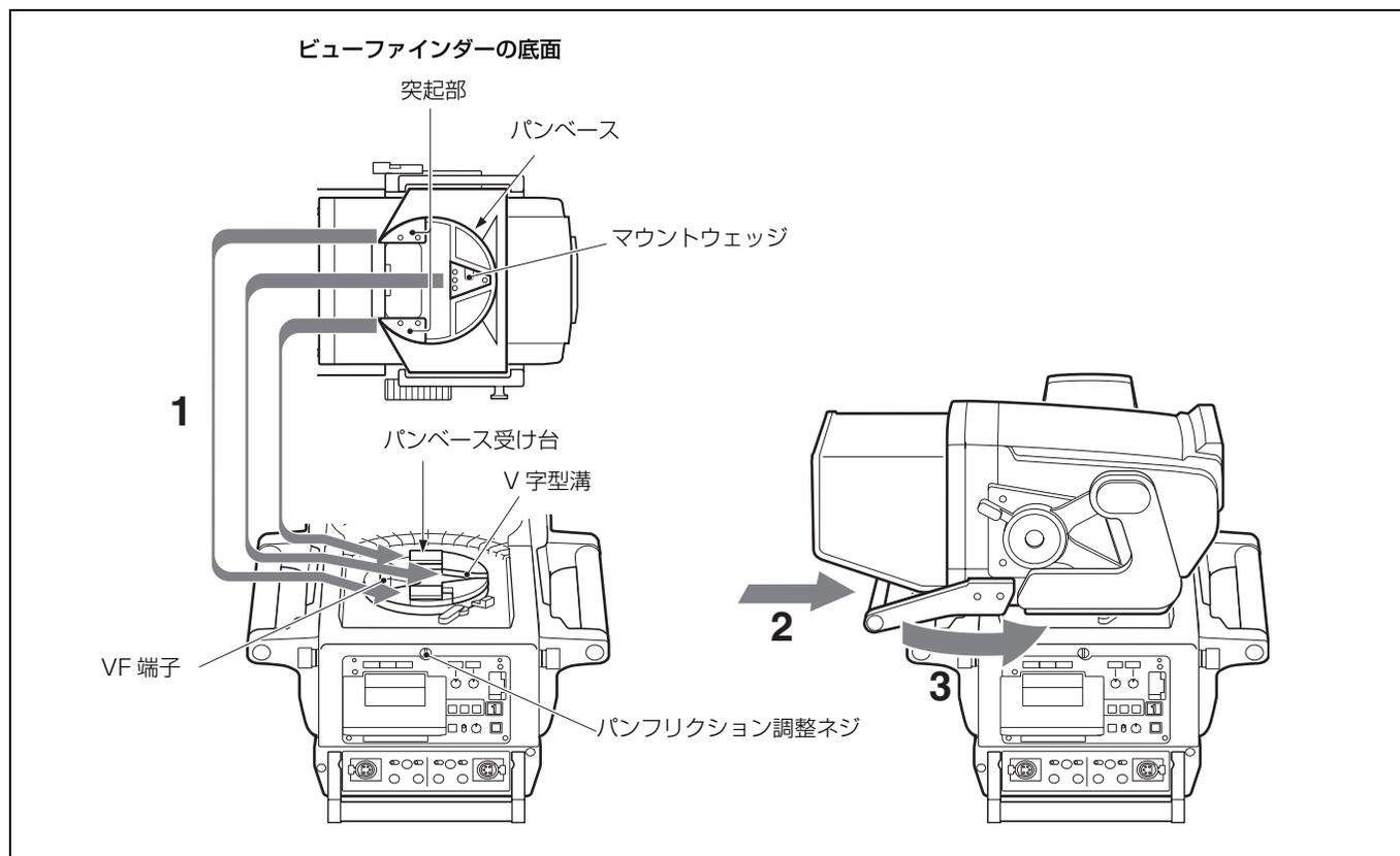
**1** ビューファインダーのパンベース裏側にあるマウントウェッジが、カメラのパンベース受け台のV字型溝の中に入るように、また、パンベース裏側の突起部が図に示す位置にくるように、ビューファインダーをパンベース受け台にのせる。
