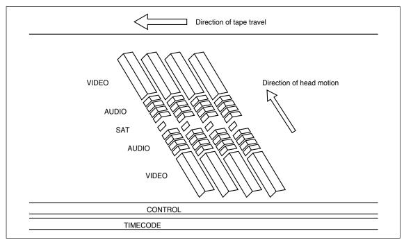
Fig. 10-2-1. MPEG IMX Format Tape Pattern
