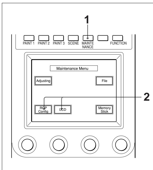
1 メニュー操作部のMAINTENANCEボタンを押して点灯させる。
