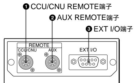
❶ CCU/CNU REMOTE(カメラコントロールユニット/カメラコマンドネットワークユニットリモート)端子(8ピン)
