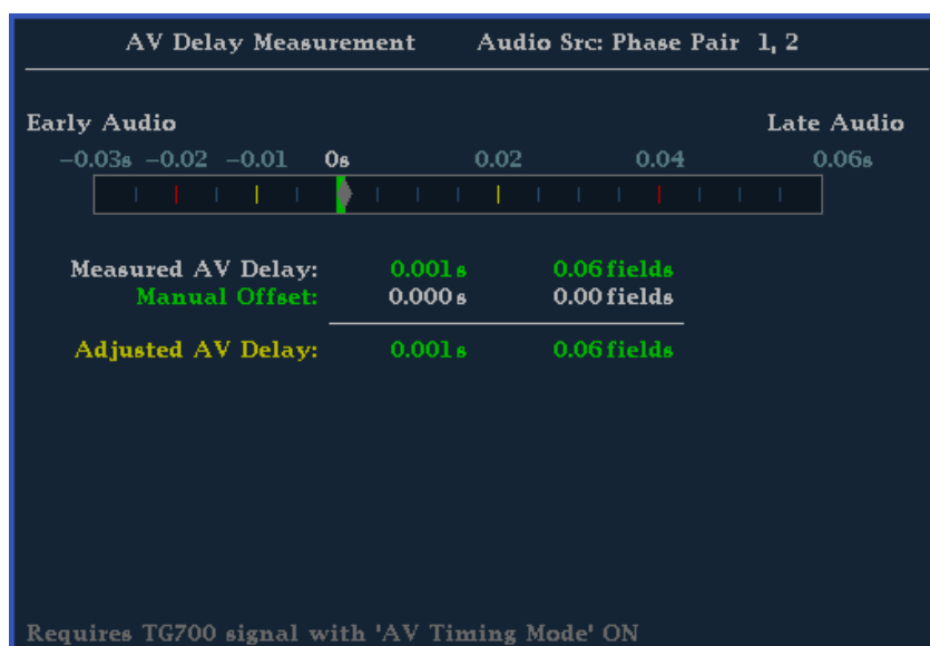
Figure 29: AV Delay display
