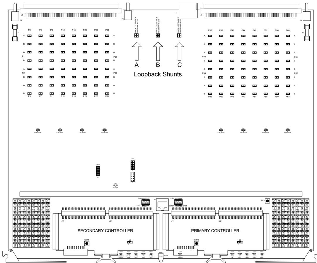
**FIGURE 4-1. Loopback Shunts**
