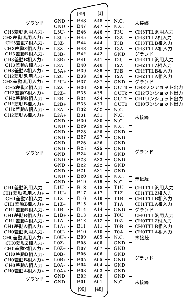
図3.2 インターフェイスコネクタ(CN1)の信号配置(ボード側)
